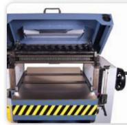
SECTIONAL INFEED ROLLER/ CHIP BREAKER AND TWIN BED ROLLERS
