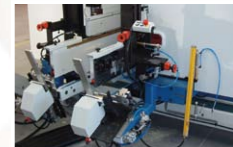
Work-piece return system to the operator with automatic stacker. Mécanisation de retour pièces à l'opérateur avec empileur automatique. Mecanización retorno piezas al operario con apilador automático.
