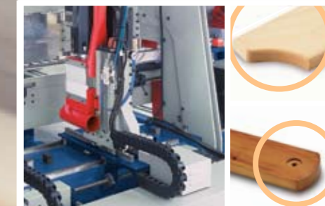
CNC vertical routing unit "J-3". Unité de défonçage vertical CNC "J-3". Unidad de pantografado vertical CNC "J-3".
