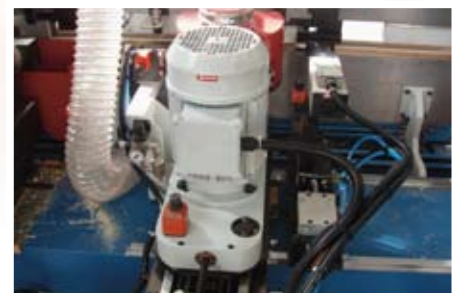
Profiling station with automatic chip-breaker system. Station de fraisage avec système de brise-copeaux. Estación de fresado con sistema automático de rompeviruta.
